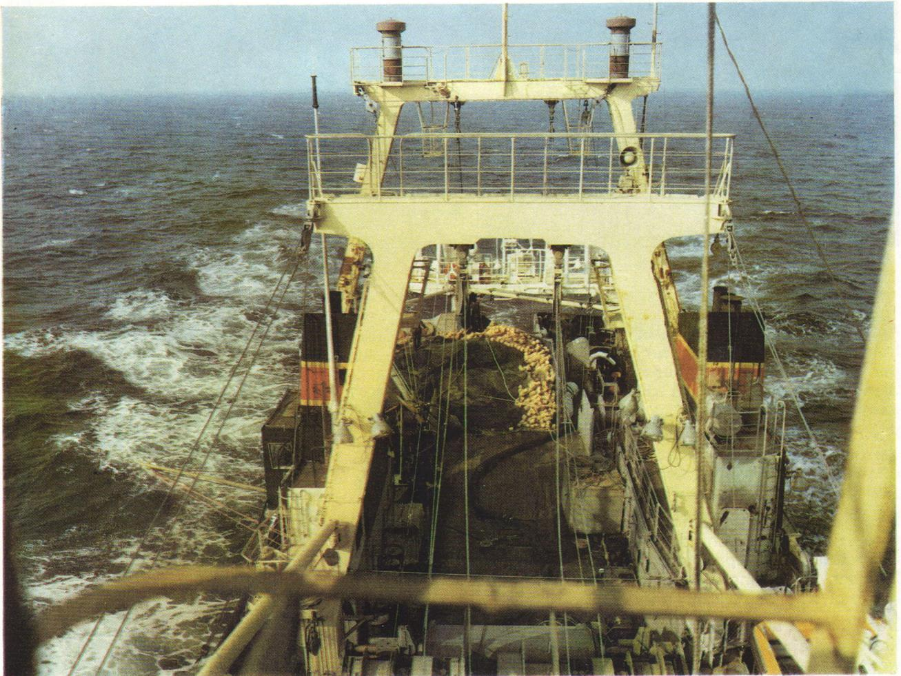
Zum Herrichten der Netzkoje wird die im oberen Bereich der Slip vorhandene Slipklappe hochgeklappt und arretiert. Zusätzlich wird das drehbar ausgeführte Stb-Schanzkleid der Slip nach achtern geschwenkt und arretiert. Dadurch entsteht eine Ringwadenablegefläche von 60 m<sup>2</sup>.
