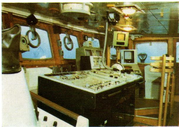
Vorderer Bereich der Brücke mit Brückenfahrstand, Radar- und Fischortungsanlagen
