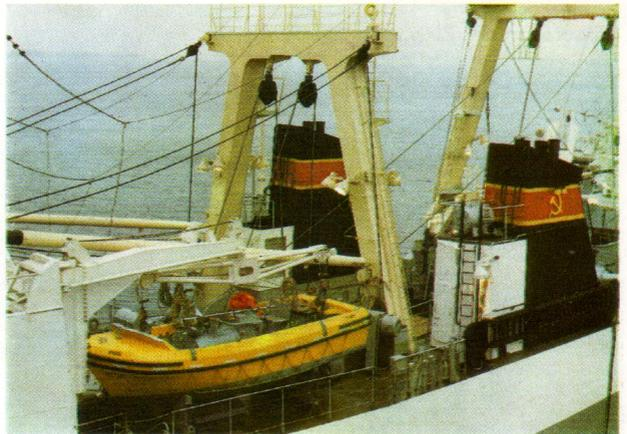
Auf der Bb-Seite des 1. Aufbaudecks ist ein Arbeitsboot angeordnet, das zur Unterstützung einiger Arbeitsgänge bei der Ringwadenfischerei dient. Außerdem wird es als Bereitschaftsboot genutzt.
