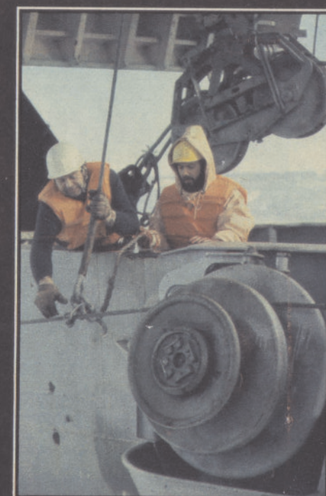
Neu für Rostocker Fischer: Die eisernen Seile (Drahtjäger) kommen in eine Leitrolle. Das verbessert den Arbeitsschutz.
