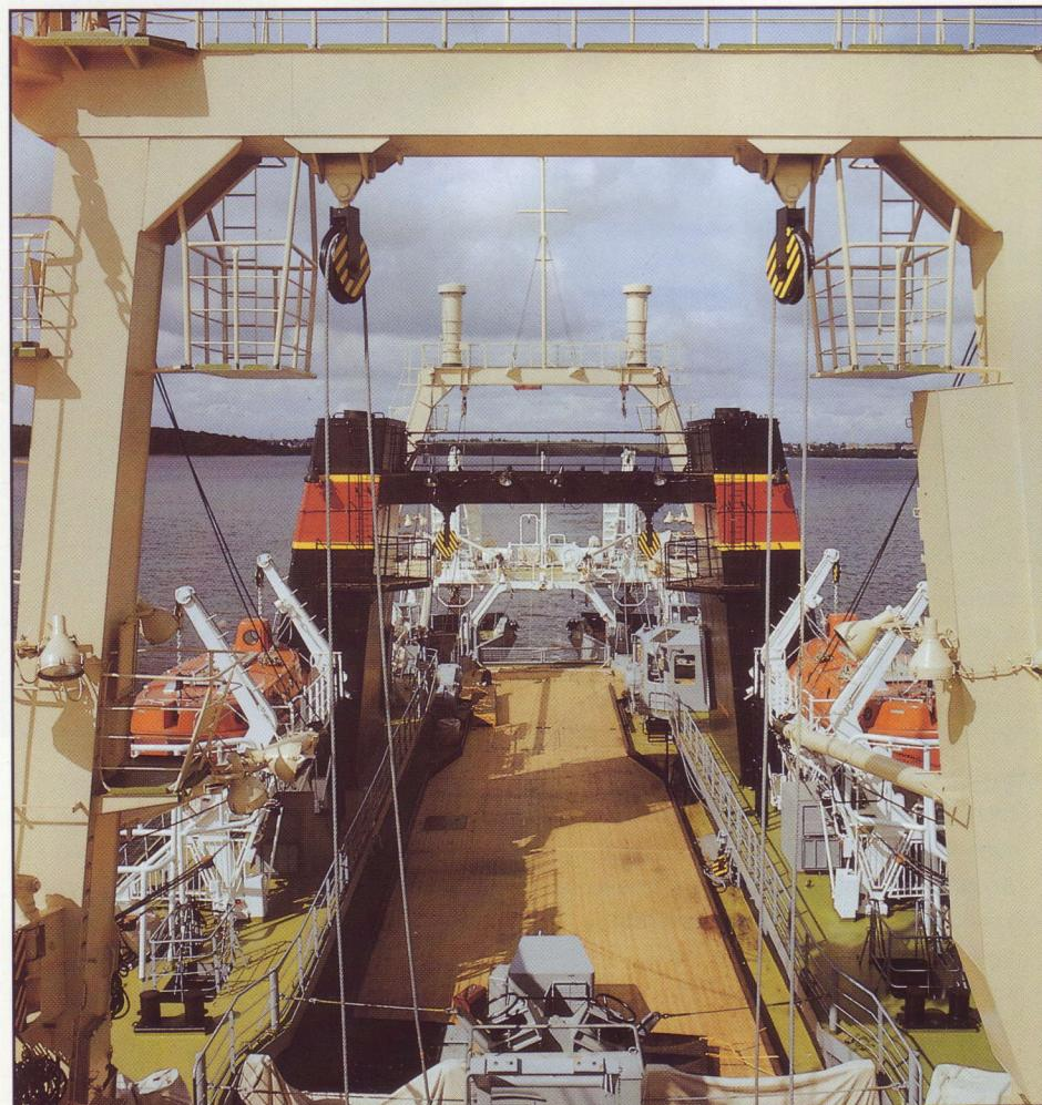
Судно оснащено для лова рыбы донным и пелагическим тралами. Размещение промыслового оборудования на палубе позволяет переход с одного вида лова на другой.
