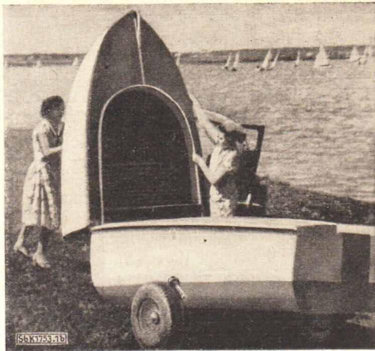
Bild 9. Das Touristenboot wird auseinandergeklappt und schwimmfertig gemacht
