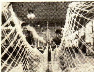
*Jährlich knüpfen erfahrene Netzmacher des Rostocker VEB Fischfang etwa 140 Netze. Das größte ist 300 Meter lang und wird für die pelagische Fischerei eingesetzt. Die Maschengrößen der Rostocker Netze liegen zwischen zwei Zentimeter und 1,60 Meter.*
