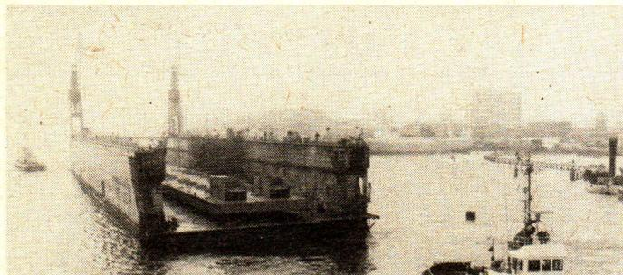
*Schwimmdock für Volkswerft. Ende Dezember vorigen Jahres schleppte der Eisbrecher „Stephan Jantzen“ ein 7500-Tonnen-Schwimmdock der Warnowwerft nach Stralsund. In dem 155 Meter langen und 33 Meter breiten Dock werden die Schiffe der neuen Fabrik-Trawler-Serie zu Wasser gelassen.*
