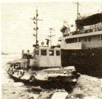
**Umschlag trotz Eis und Schnee.** Eisdicken von durchschnittlich 15 Zentimeter Stärke wurden im Januar auf den Seewasserstraßen der DDR gemessen. Den Einsatz eisbrechender Schlepper koordinierte die Zentrale Eisbrecherleitstelle des Seefahrtsamtes. Auf dem Foto beseitigt der Schlepper „Grabow“ treibendes Eis zwischen einem sowjetischen Schiff und seinem Stralsunder Liegeplatz.
