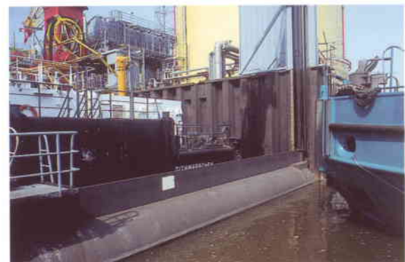
Abgesenktes Hubtor während der Ölverladung.
