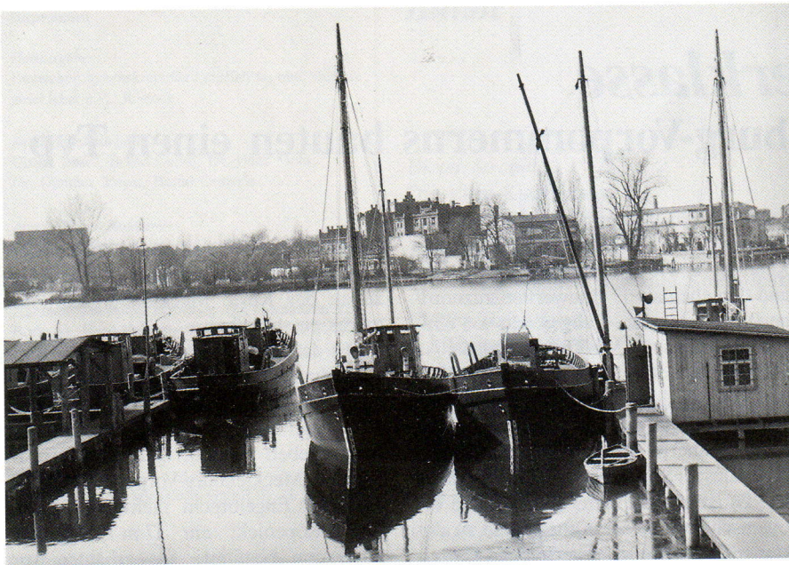
Bild 2: Die Claus Engelbrecht Yachtwerft GmbH Berlin-Köpenick fertigte 152 Kompositfischkutter Typ D als Reparation für die UdSSR
